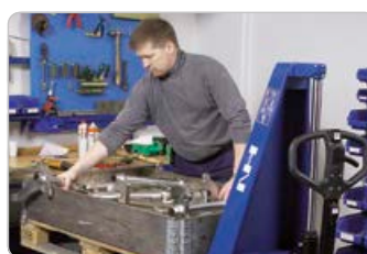
Anbringer lasten i ergonomisk korrekt arbejds højde
